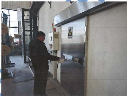
图4 防护门外表面检测照片
