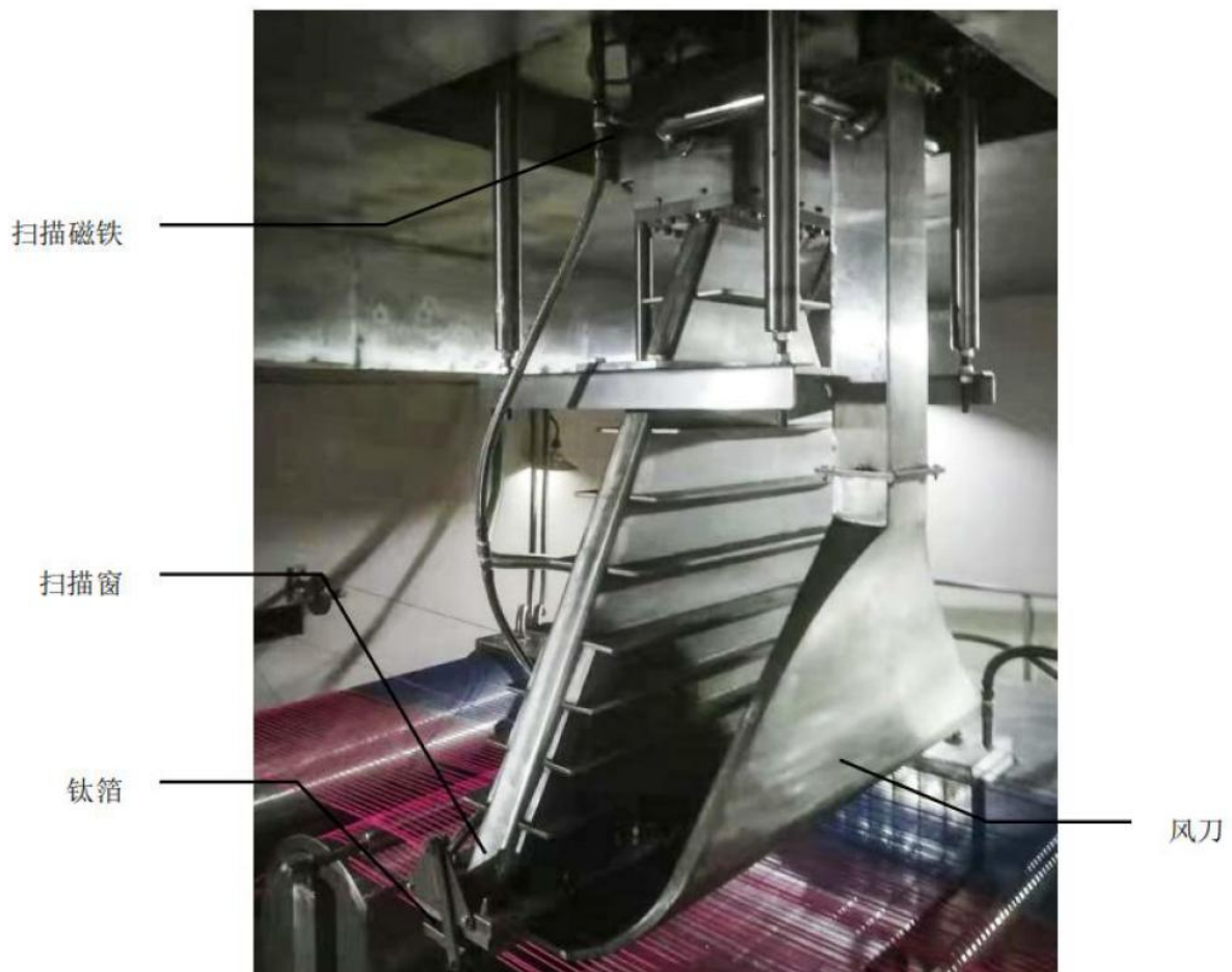
图 9-7 束流引出系统示意图
